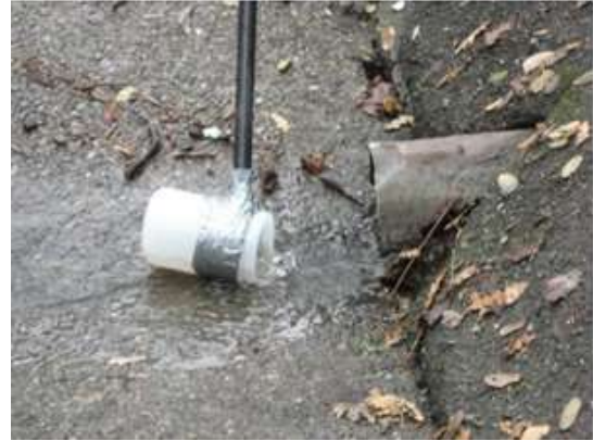
Hình 2-6: Cách lấy mẫu nước mưa chảy tràn
