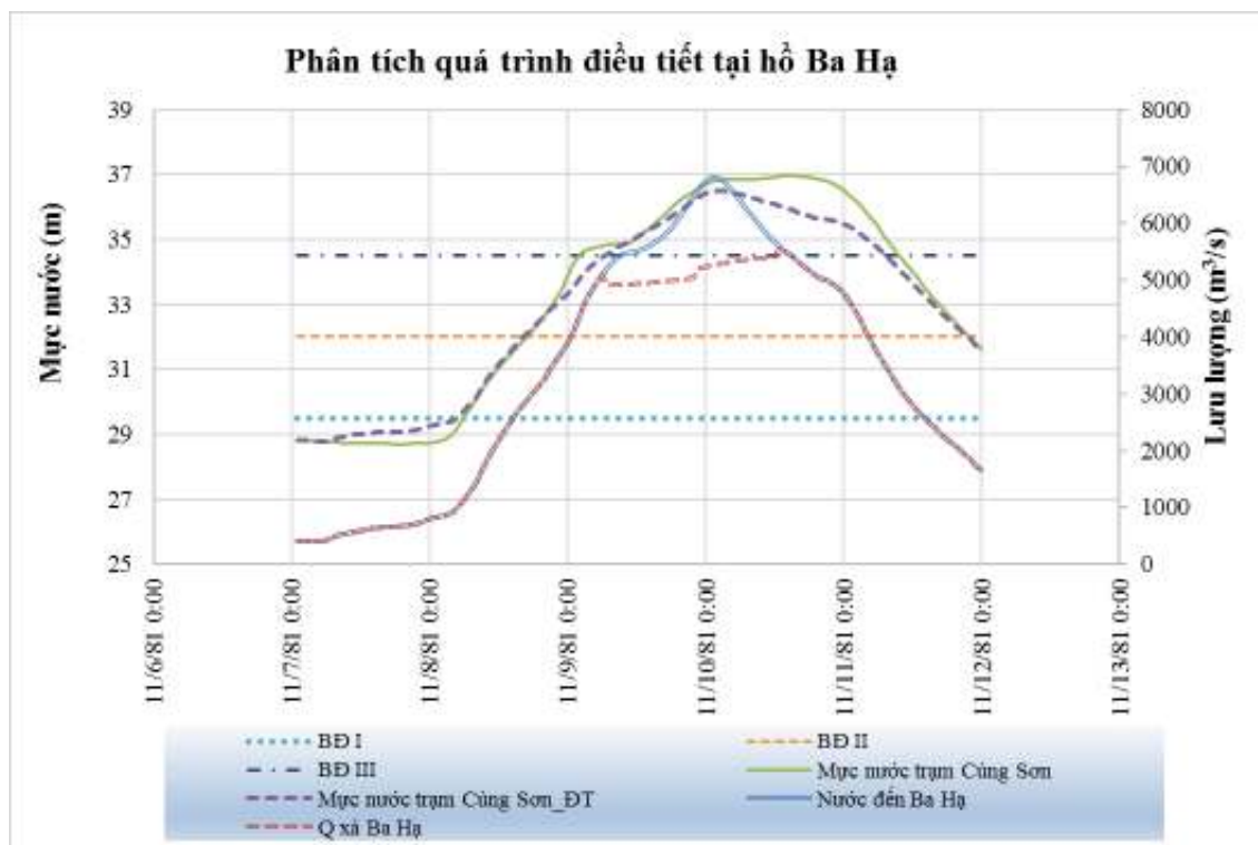
Hình 4.9. Kết quả vận hành cắt giảm lũ hồ Sông Ba Hạ năm 1981
