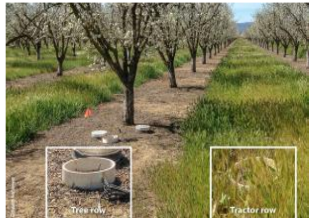
Hình 1.10: Lấy mẫu KNK qua các hộp đo khí thủ công tại vườn mận ở các vị trí khác nhau tại California, Mỹ
