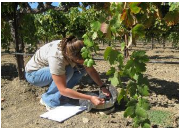
Hình 1.11: Lấy mẫu khí phân tích N_2O phát thải từ đất ở vườn trồng nho tại California, Mỹ
