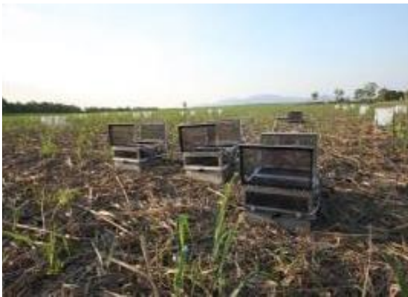
Hình 1.9: Lấy mẫu KNK sử dụng kỹ thuật buồng tự động và thủ công trong trồng mía tại Queensland, Australia
