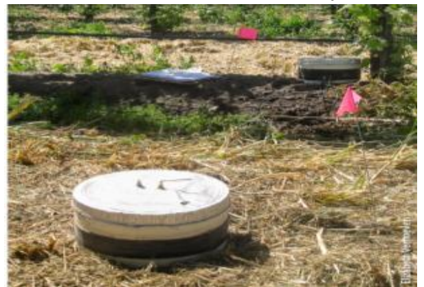
Hình 1.11: Lấy mẫu khí phân tích N_2O phát thải từ đất ở vườn trồng nho tại California, Mỹ
