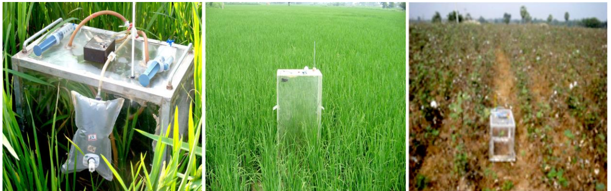
Hình 1.6: Thiết bị đo khí nhà kính cho lúa và cây trồng cạn tại Ấn Độ
