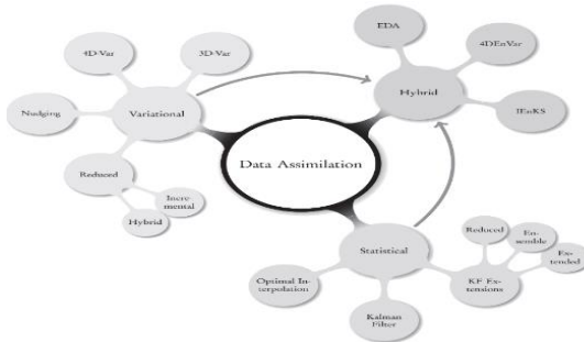
Hình 1. 1. Sơ đồ tổng quát các phương pháp và kỹ thuật đồng hóa số liệu cho mô hình số hiện nay (M. Asch, M. Bocquet, M. Nodet, 2017)
